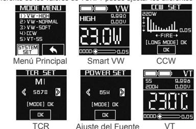
**Ajuste de la temperatura:** En el modo de TC-Ni/TC-Ti/TC-SS/TCR(M1,M2), la temperatura se puede ajustar de 100 a 315 °C o de 200 a 600°F presionando el botón de arriba o inferior. Y el botón de arriba es para aumentar la temperatura, en cambio, el inferior significa rebajar la temperatura. Cada vez que presione el botón de arriba o inferior aumentará o rebajará el 5 °C o 10 °F. Mantenga pulsados los botones para aumentar o rebajar rápidamente la temperatura.
