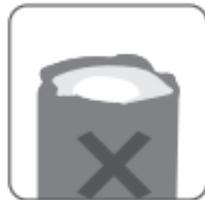
正极绝缘皮破损
