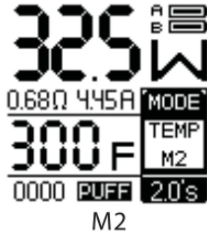
在温控模式下更换发热丝，待雾化器冷却至室温后再安装发热丝，发热丝安装完毕，显示屏会显示发热丝的初始阻值，如果这个数值准确，就可以直接使用，如果数值不是很精确，需要校正阻值后再使用。
