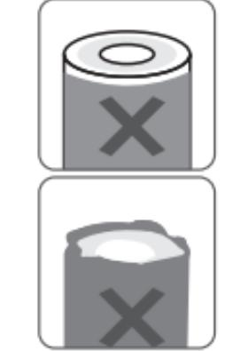
正极绝缘皮破损
