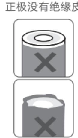
正极绝缘皮破损
